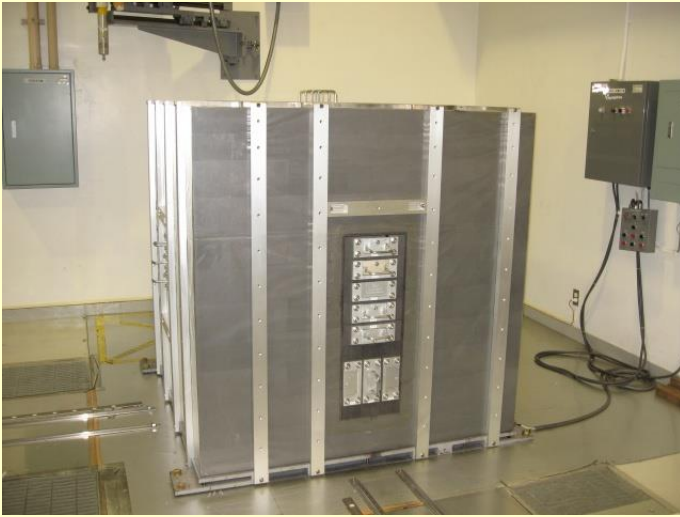
黒鉛パイル（熱中性子用）
